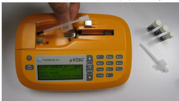
2. サンプルを Auto モード、および Advanced モードで試験します。
