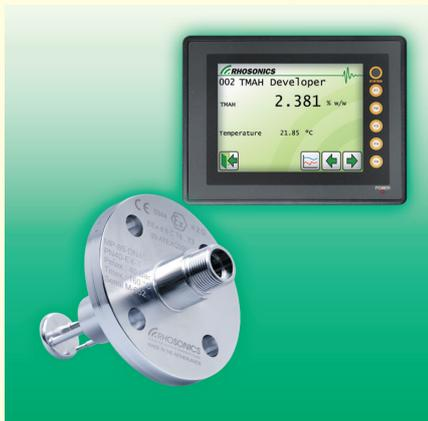
シリーズ 8500 化学プロセスアナライザは、UMPシリーズセンサの反射型または透過型プローブを装備しています。モデル8500 シリーズは流体中の音速測定を原理とする、2成分流体の測定に適したアナライザです。センサは配管、タンク内壁、またはフローセルに取り付けます。NaOH、NH4OH、H2SO4、HCl、NH4、アルコール、アンモニア中の水分、水中のオイル、オイル中の水分、など
