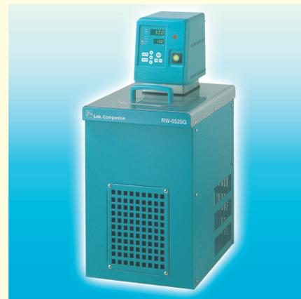
水槽容量は、4サイズ(5L,10L,20L,30L)。過昇温度防止、空焚防止等の安心安全装置なCLS統合安全システム搭載で冷凍機のスイッチを無くしました。温度校正機能。よく使う3つの温度をメモリー保存可能。自動タイマー運転機能でON-OFF可能。パワフル吐出量は5段階調節可能。パソコンと接続して温度プログラマー機能を利用可能。環境に適合した冷媒ガス(R134a、R404a)を使用
