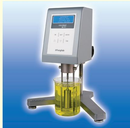
付属のUSBケーブルでパソコンに接続すれば、EXCELファイルでデータを転送することができます。別途付属のアクセサリーにてシアレート・シアストレス表示可能。測温センサー付属。温度測定も同時に可能です。回転数は、0.3~100rpm、18段切替。タイマー・オートストップ機能付き、粘度校正機能有り、キャリングケース付属。
