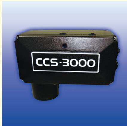
石炭・コークス・シンターミックス・鉄鉱石・鋳物資材等の黒色系の物質の計測感度が難しい物質中の水分を感度良く計測可能な高感度水分計です。
