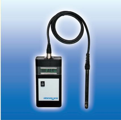
測定場所を選ばない携帯型粘度計。測定プローブをサンプルに挿入するだけの簡単操作で温度も同時に測定可能。少量サンプル (0.3ml) でも測定が可能。
