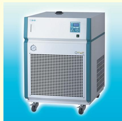
充実した安全装置を搭載したHXチラーは6機種。冷却効率の最適化による省エネ設計。冷却能力は(1.9~4.7Kw/20℃)の6機種。ポンプ及びバルブは選択変更が可能。LED液面レベルゲージ、警報ブザー、圧力ゲージ、キャスター付き、コンパクト設計。環境に適合した冷媒ガス(R404A)を使用。豊富なアクセサリ・パーツ有り
