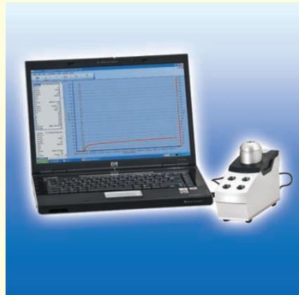
フリーオシレーション方式を採用した少量サンプル低粘度測定装置。血清・血液・唾液等のバイオケミカルのサンプルに適した試料容器はディスポーザブル・タイプ。サンプル量=600~1000 $\mu$ l、 $\eta$ =0.5~6mPa.s又は5~60mPa.s(試料容器による)、 $G'$ =30~30,000Pa、T=30~50℃。オプション:粘弾性 $G''$ 、温度制御機能、PCソフト、オプション:37℃保温機能
