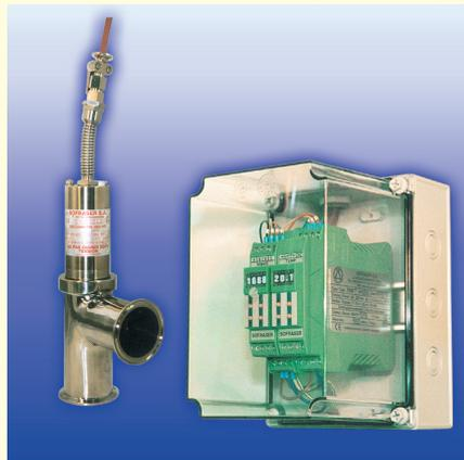
高温・高圧・高粘度・スラリー物質のアプリケーションに対応した耐久性に優れたプロセス用振動式粘度計。配管、タンクに直接取り付け、連続的に粘度・温度・温度換算粘度・PID制御出力が得られます。国内耐圧防爆仕様認可取得済。
