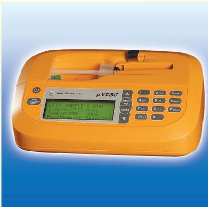
サンプルはマイクロピペットで約100 $\mu$ lの微量でスピーディーな測定が自動で行えます。耐溶剤性に優れ、アドバンスモードでは、任意のずり速度を指定した測定条件での粘度測定が出来ます。データは、粘度・温度・ずり速度・ずり応力・流量・ID番号等の情報が表示されPCに保存も可能です。粘度測定範囲は、低粘度・中粘度・高粘度センサーカートリッジを交換するだけで広い粘度範囲をカバー出来ます。粘度測定範囲:0.2~20,000mPa.s。オプション:温度コントローラーも有ります。
