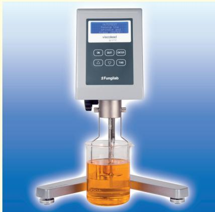
日本語表示機能を搭載し、操作性に優れた粘度計。スピンドル番号と回転数を設定するだけで粘度測定が行えます。リアルタイムで、粘度・回転数・スピンドル番号・%トルクがデジタル表示されます。回転数は、0.3~100rpm、18段切替。トルクオーバーの自動停止機能搭載。粘度測定範囲は、詳細カタログを参照下さい。オプション:APM, LCP他
