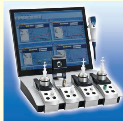
フリーオシレーション方式を採用した少量サンプル低粘度測定装置。血清・血液・唾液等のサンプル4点同時に測定可能な上位機種。バイオケミカルのサンプルに適した試料容器はディスポーザブル・タイプ。サンプル量=600~1000 $\mu$ l、 $\eta$ =0.5~6mPa.s又は5~60mPa.s(試料容器による)、 $G'$ =30~30,000Pa、T=30~50℃。オプション:粘弾性 $G''$ 、温度制御機能、PCソフト、オプション:37℃保温機能
