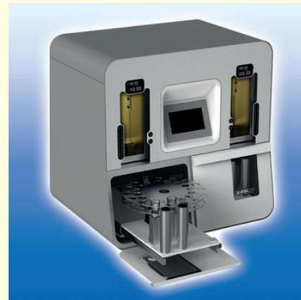
オートサンプラー付き全自動のサンプリング、測定、洗浄、乾燥迄、データ保存まで全自動で出来るウペローデ型の全自動動粘度計。必要サンプル量は8~12ml。二槽タイプ。日本語表示機能で操作性に優れています。ISO3104 認証規格品。粘度インデックスの自動計算機能搭載。粘度管は、測定粘度範囲により選択が可能。各槽に2本ずつ計4本設置が可能なタイプです。
