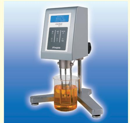
回転数は、0.01~200rpmの54段設定、付属のUSBケーブルでパソコンに接続すれば、EXCELファイルにデータを転送することができます。別途付属のアクセサリーにてシアレート・シアストレス表示可能。測温センサー付属。温度測定も同時に可能です。回転数は54段切替。キャリングケース付属。少量サンプル容器APMでプログラム設定機能を使用すれば、シアレート・シアストレスの関連データが取れます。粘度-温度のグラフも可能。
