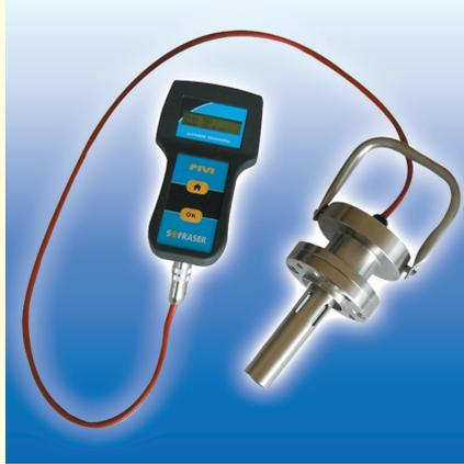
測定場所を選ばない携帯型粘度計。測定プローブをサンプルに挿入するだけの簡単操作で温度も同時に測定可能。非ニュートン流体、スラリー溶液でも測定が可能。
