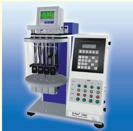
サンプル投入のみ手動で予熱時間、洗浄溶剤も少なくスピーディーな測定、洗浄、乾燥が全自動で出来る自動動粘度計。必要サンプル量は0.3~0.4mlの少量タイプ。日本語表示機能で操作性に優れています。ISO3104 認証規格品。40℃、100℃の二槽タイプのS-Flow3000型も有ります。
