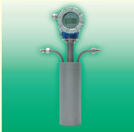
腐蝕性サンプル迄広範囲のアプリケーションに対応する振動式精密密度・濃度計。化学工場で使用が出来る本質安全防爆仕様様の6桁表示の密度・濃度計。2線シールドテクノロジー製品。接続配管 1/2B, 1B。
