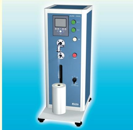
サンプルを完全真空下で加熱する事によりサンプル中の水分を蒸気圧の上昇値で高度で測定し水分値を表示させるマノメーター式水分計です。薬品を全く使用しない簡単操作です。水分測定範囲:30ppm~約5%、ISO15512、JIS-K7251認証規格品。
